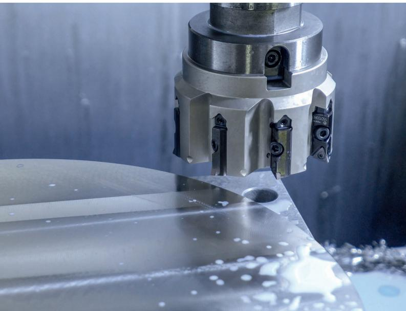
4 Der Schlichtfräser MikroMill, hier beim Bearbeiten des Schiebers, erzeugt eine Oberfläche mit solch hoher Qualität, dass das Schleifen ersetzt werden kann
