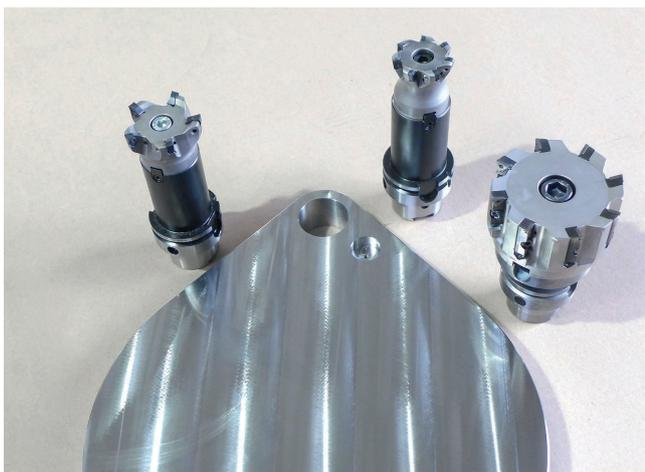
3 Fertiger Schieber für die Lebensmittelindustrie mit den drei an der Zerspanung beteiligten Fräs Werkzeugen HiFeedMini (Mitte), DiPosHexa (links) und MicroMill (rechts) (© Ingersoll Werkzeuge)
