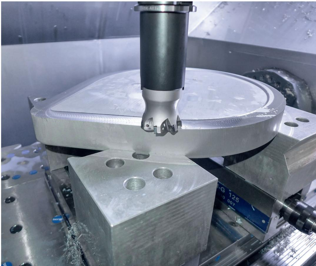
1 Vorteile des Hi-FeedMini-Fräasers von Ingersoll wie ein ausgeprägt ›weicher‹ Schnitt und ein ruhiger Lauf macht sich der österreichische Lohnfertiger Simtec zunutze, hier beim Fräsen eines Werkstücks für die Lebensmittelindustrie
